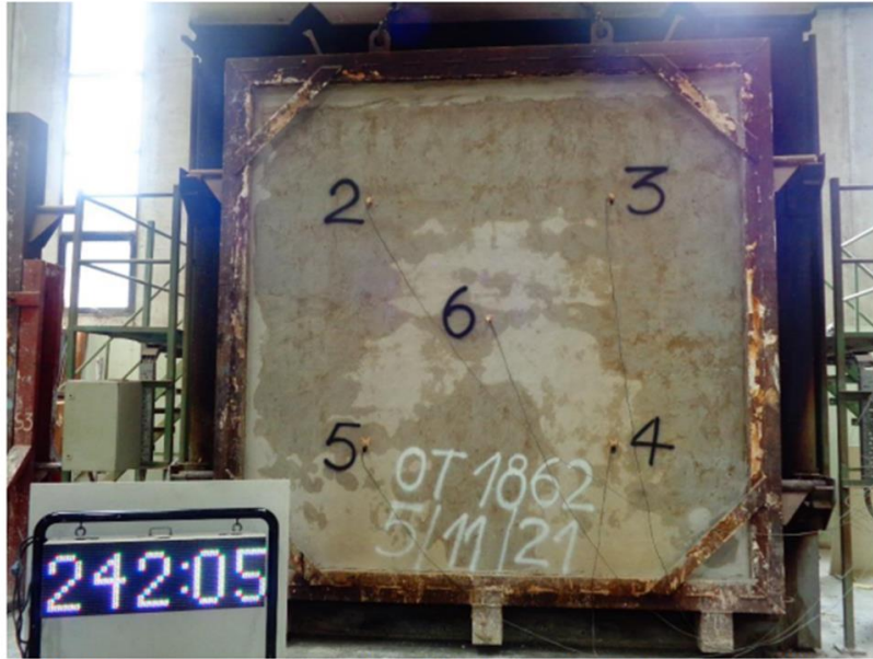
Foto 11- Aspecto de la muestra a los 242 minutos desde el comienzo del ensayo, momento previo a la interrupción del mismo.
