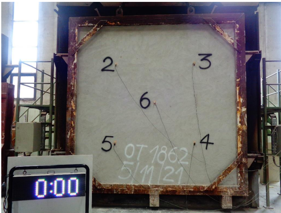
Foto 2- Aspecto de la cara no expuesta de la muestra antes del comienzo del ensayo.
