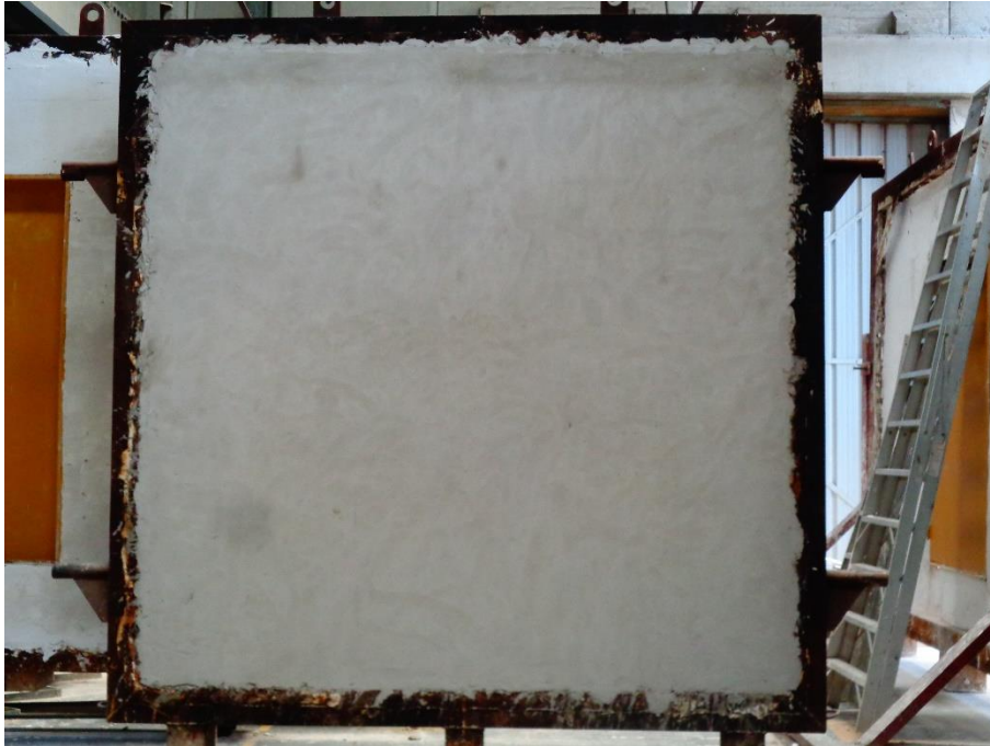
Foto 1- Aspecto de la cara expuesta de la muestra antes del comienzo del ensayo.
