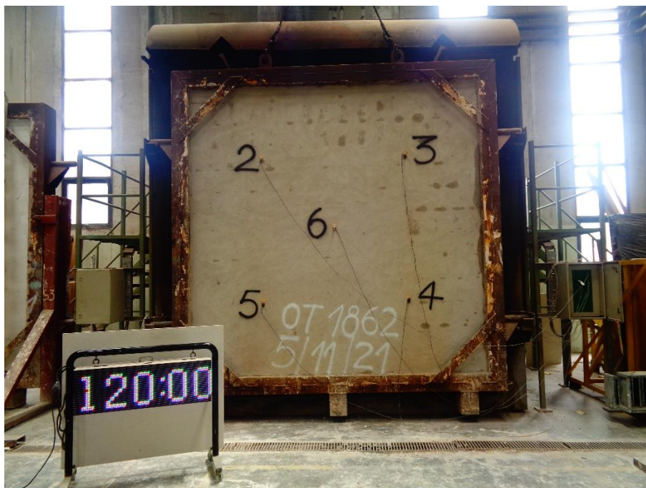
Foto 8- Aspecto de la muestra a los 120 minutos desde el comienzo del ensayo.
