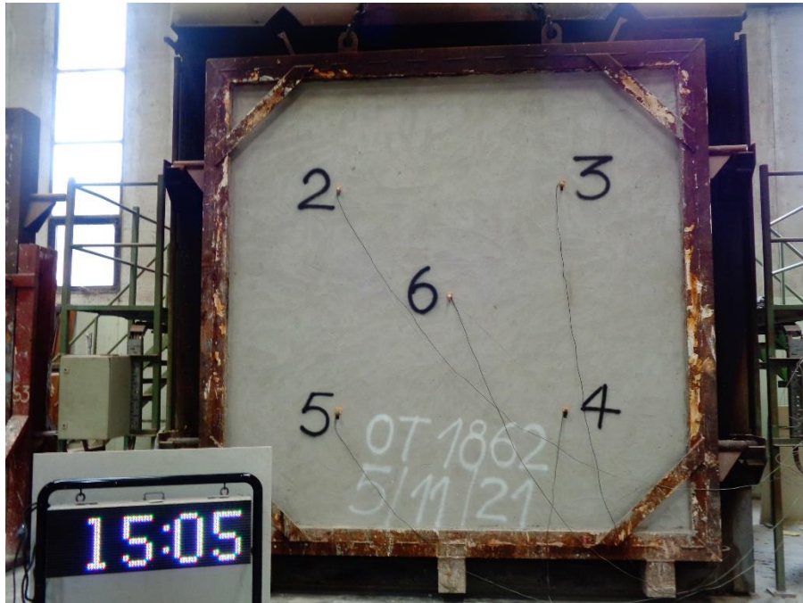
Foto 3- Aspecto de la muestra los 15 minutos desde el comienzo del ensayo.
