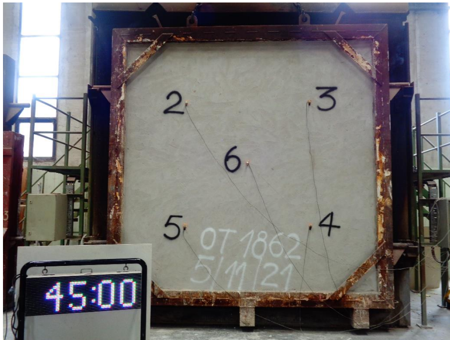
Foto 5- Aspecto de la muestra a los 45 minutos desde el comienzo del ensayo.
