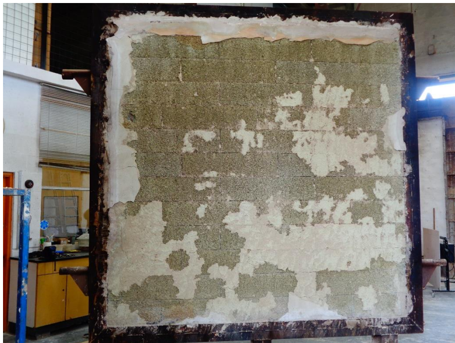
Foto 12- Aspecto de la cara expuesta de la muestra una vez terminado el ensayo.
