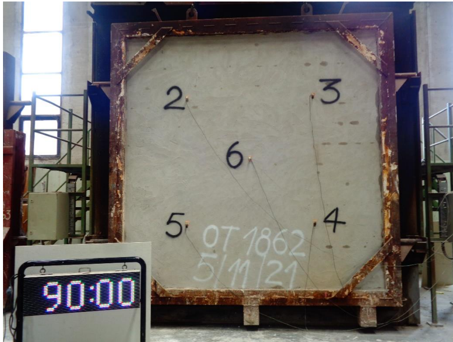
Foto 7- Aspecto de la muestra a los 90 minutos desde el comienzo del ensayo.
