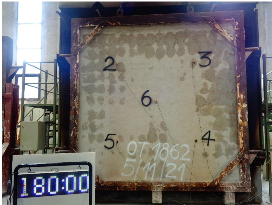
Foto 9- Aspecto de la muestra a los 180 minutos desde el comienzo del ensayo.
