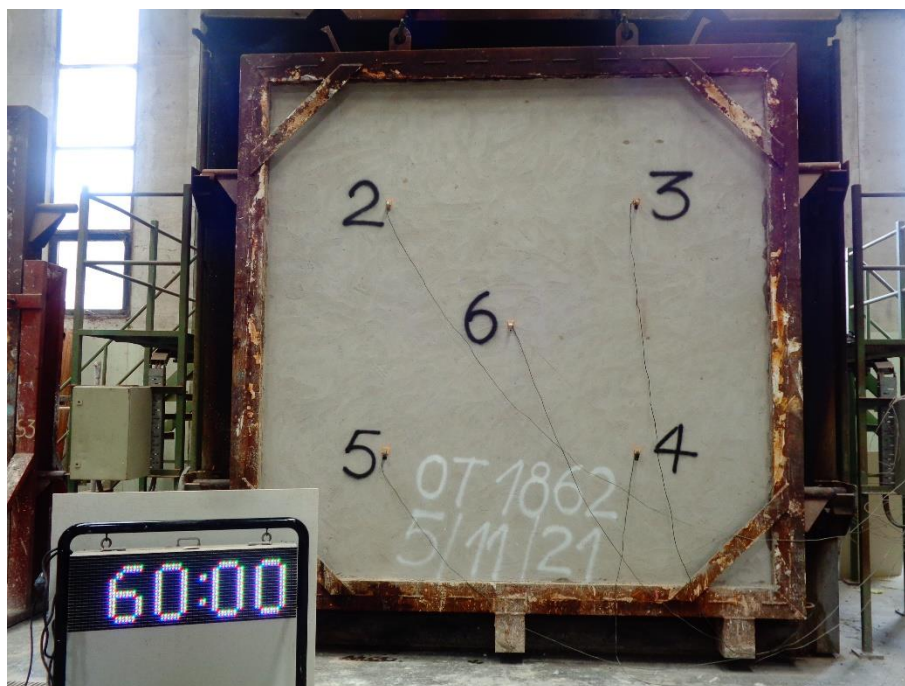
Foto 6- Aspecto de la muestra a los 60 minutos desde el comienzo del ensayo.
