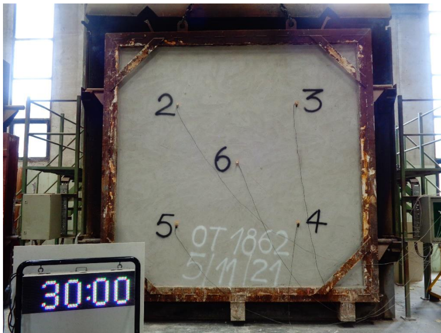
Foto 4- Aspecto de la muestra a los 30 minutos desde el comienzo del ensayo.
